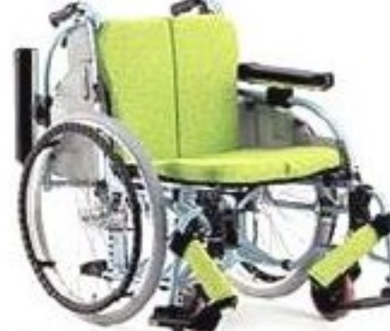
能够以拆卸或翻转等方式进行活动的扶手,便于使用者从轮椅与床、浴盆、坐便和汽车间的移动
